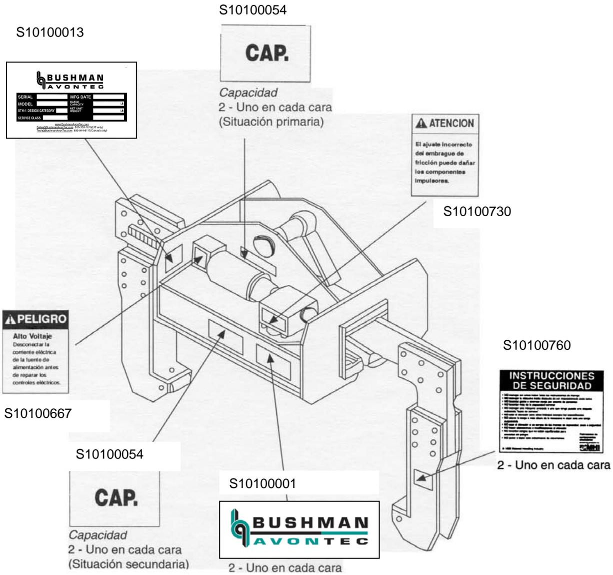
**NOTA:** Advertencias de alto voltaje aparecerán en las cubiertas de los tableros eléctricos y de las cajas de conexiones cuando se suministren controles eléctricos.
